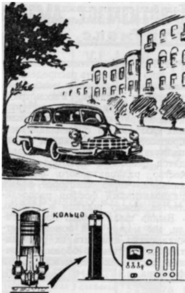
*Установка для измерения радиоактивности масла, с помощью которой можно определить степень износа бензинового двигателя.*
